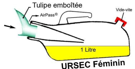
→ **INCLINAISON DE L'URSEC:** il doit offrir une pente suffisante pour que l'urine s'écoule par gravité. Ne pas relever **URSEC** jusqu'à la verticale, l'air ne partirait plus.
